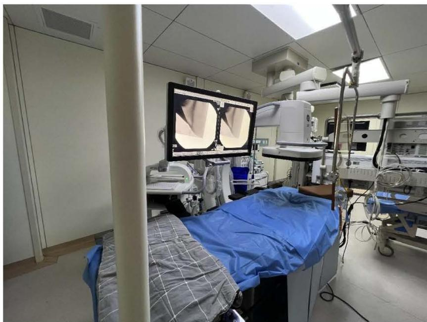
图 2-4 C 形臂 X 射线机实物照片
